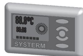
**6.E2- Centralina ricevente WSC . La centralina riceve le informazioni dal cronotermostato trasmettitore WST01 e agisce da attuatore, accendendo e spegnendo, le elettrovalvole o i dispositivi elettronici di comando dei sistemi di riscaldamento installati.**
